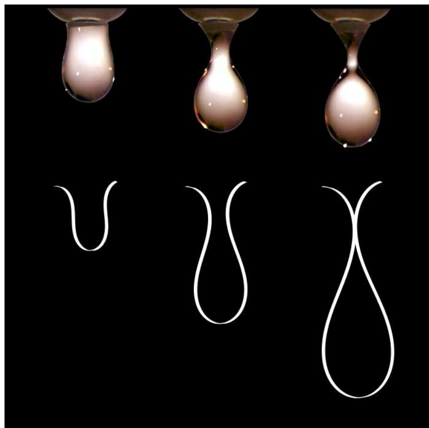
Fig. 3 - The dripping of water and of an elastic rod. La formazione di una goccia d'acqua e il dripping di una asta elastica (foto Diego Misseroni, archivio Università di Trento)
